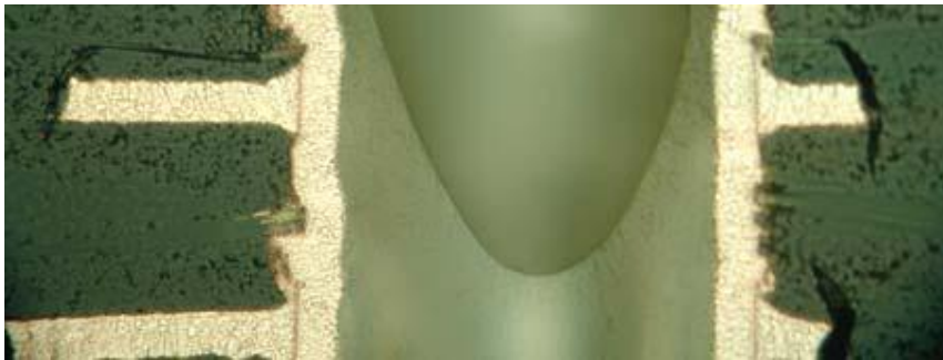
Example of Eyebrow Cracking (D)
